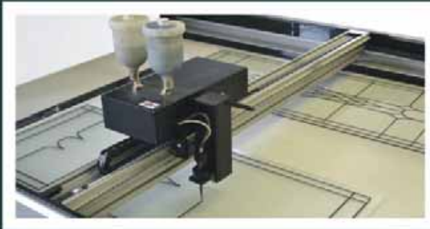
1 Laying of the resin outline on the glass surface. Auftragen des Harzrahmens auf die Glasoberfläche. Application du cadre de résine sur la surface du verre.
